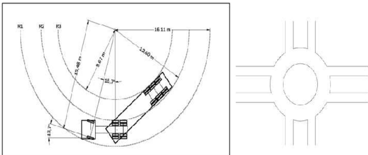
Figura 4.10 – Definição do raio mínimo para manobra da carreta de três eixos.
